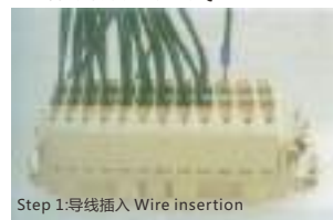
Step 1: 导线插入 Wire insertion
